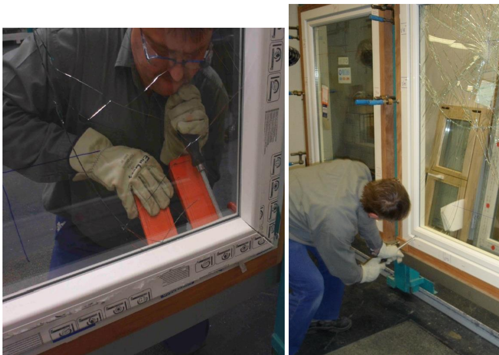
Figura 3. Ensayo de resistencia a intentos manuales de efracción
