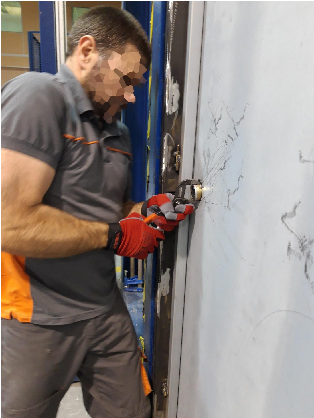
Figura 5. Ataque al conjunto cilindro y escudo (según UNE-EN 1630)
