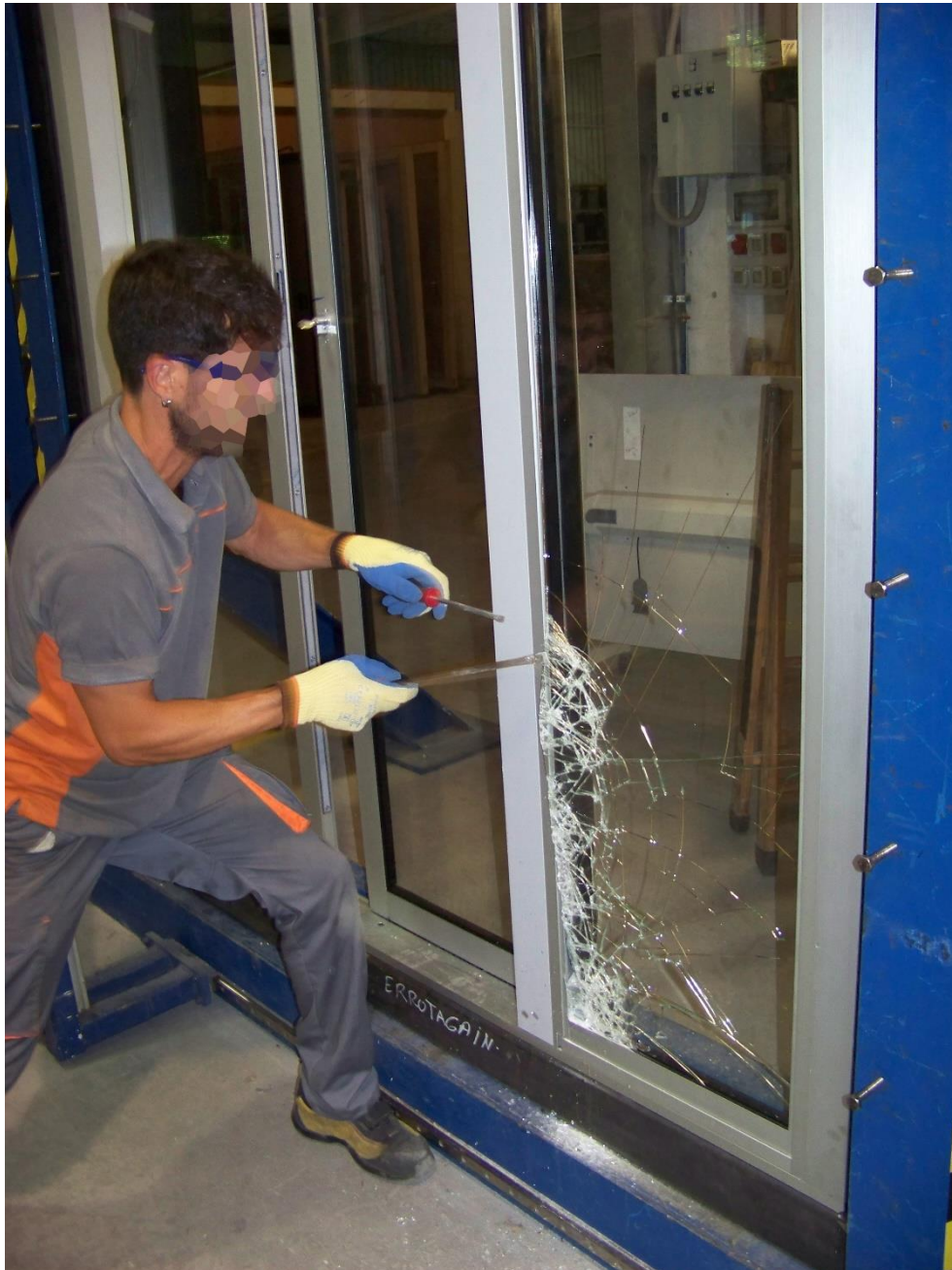
Figura 7. Ensayo de ataque manual a una puerta automática
