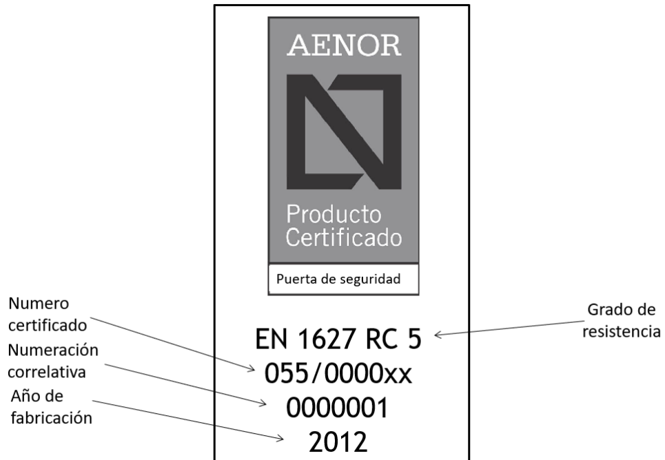
Figura 12. Ejemplo de etiqueta para puertas de seguridad
