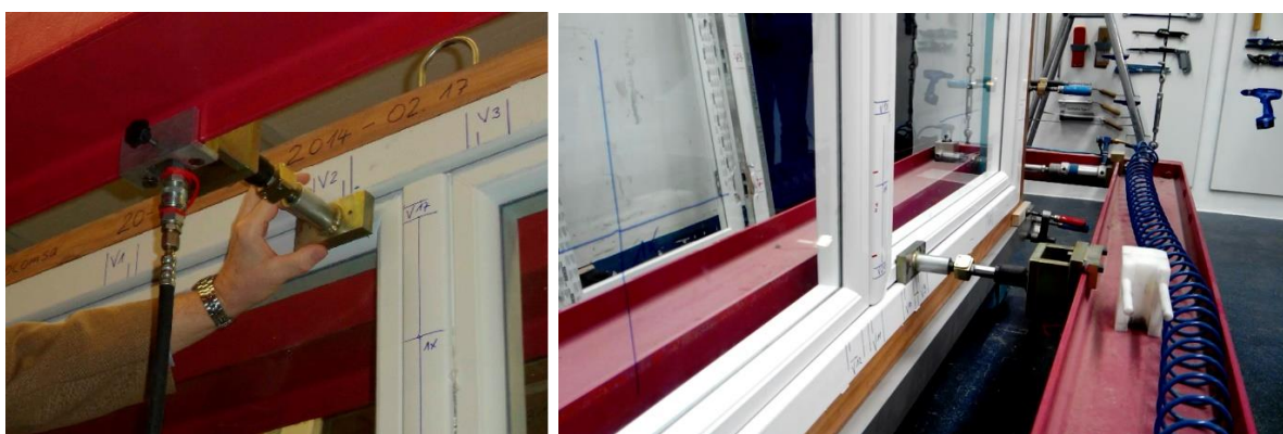
Figura 1. Ensayo de resistencia bajo carga estática
